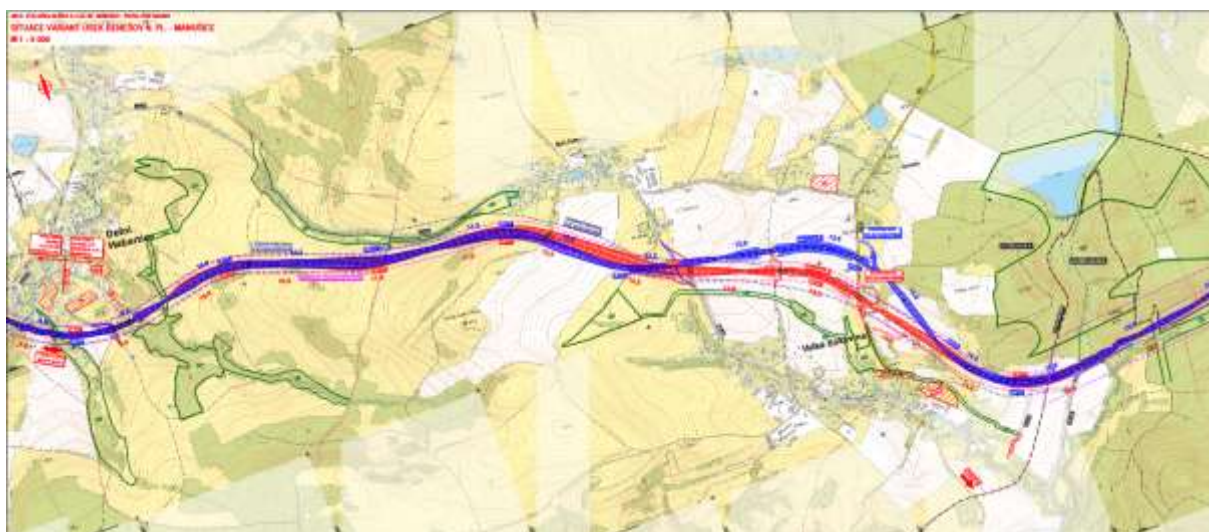
obrázek č. 50 Přeložka I/13 Benešov nad Ploučnicí – Manušice – prověření variant, úsek Benešov nad Ploučnicí – Manušice, zdroj dokumentace aktualizace technické studie, Přehledná situace z 03/2021
