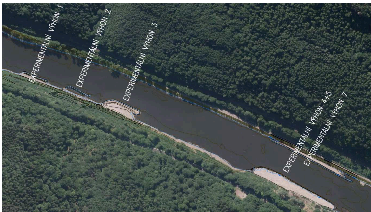
Obrázek 2 - Ortofotomapa experimentálních výhonů, V3 a V4/5 byly upraveny v roce 2014, v roce 2016 byly na výhonu V3 a V4/5 upravena pláž za korunou výhonu
