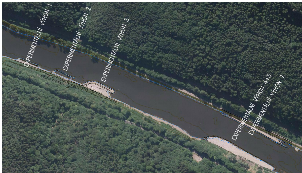
Obrázek 1 Schéma experimentálních výhonů, V3 a V4/5 byly upraveny v roce 2014, v roce 2016 byly na výhonu V3 a V4/5 upravena pláž za korunou výhonu
